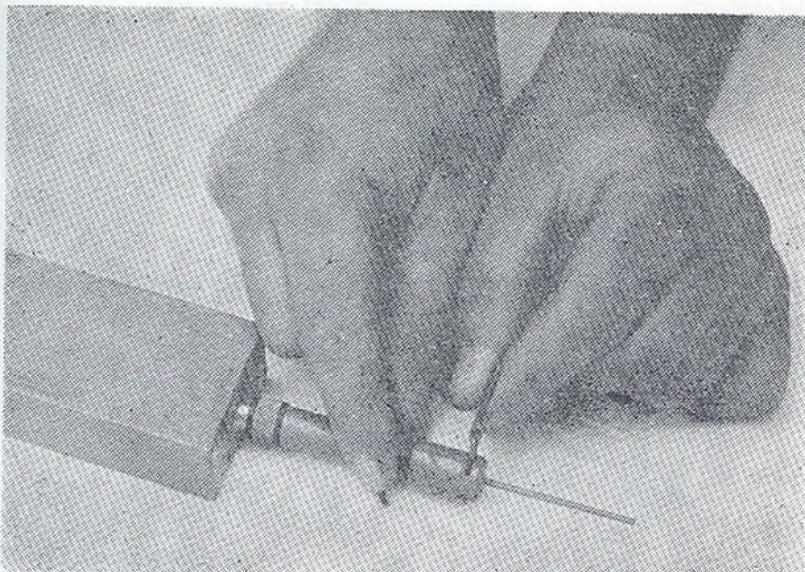
Sl. 64. Razoružavanje mine iznenađenja naoružane zglobnim upaljačem-1
